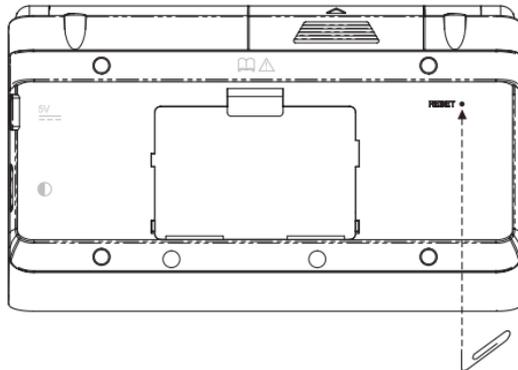
**Warnung!** Wenn Sie die Reset-Taste zu stark drücken, kann Ihr Gerät dauerhaft ausgeschaltet werden. Außerdem können beim Zurücksetzen des Gerätes Einstellungen und Informationen, die in das integrierte Buch und die installierte Buchkarte eingegeben wurden, gelöscht werden.
