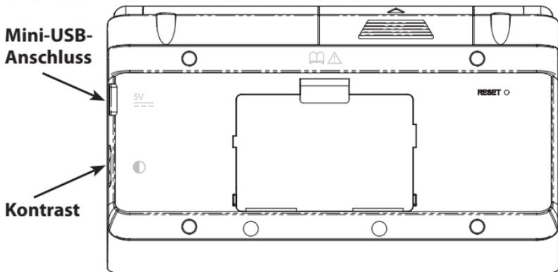
**Mini-USB-Anschluss:** Schließen Sie das Gerät unter Verwendung eines Mini-USB-Adapters (erhältlich unter [www.franklin.com/de](http://www.franklin.com/de)) über den Mini-USB-Anschluss an eine externe Stromquelle an. **Warnung!** Bitte verbinden Sie den Mini-USB-Anschluß Ihres Geräts ausschließlich mit einem Ladegerät. Die Verbindung mit einem Computer kann diesen beschädigen.
